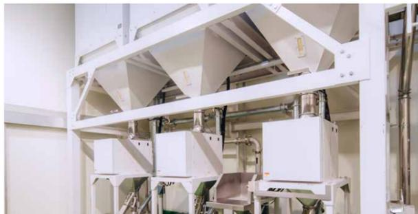
ピット不要で床置き可能なワイドホッパにお米を張り込み、流下式選別機を通すことで、糠玉や碎米などの異物を除去。コメを貯める納米タンクは、容量2tを標準とし、必要に応じた本数を設置することができます。また、エア搬送によりお米を傷つけることなく洗米機へ。残留米が残らないためロット切り替え時のタイムロス削減し、メンテナンス性も向上しました。
