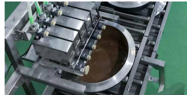
調味料を添加する「調味タンクユニット」は、重量計量方式で5種類まで標準対応。調味供給装置までポンプで供給し、「減算式ロードセル計量」で釜へ供給されます。2本の攪拌ノドルで調味料を攪拌してならします。丸釜形状のため、攪拌ムラが少ないのが特長です。
