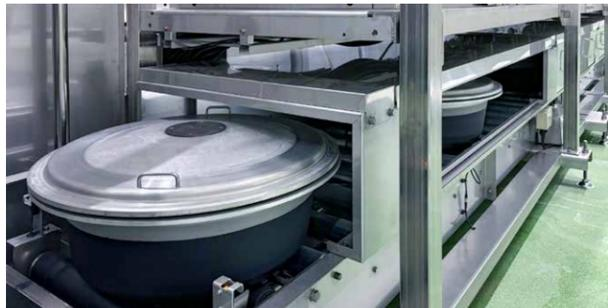
ご飯が炊き上がったら下段に移し、25分間の蒸らし工程へ。蒸らし装置の庫内は、電気式温風で60℃前後に自動で制御します。
