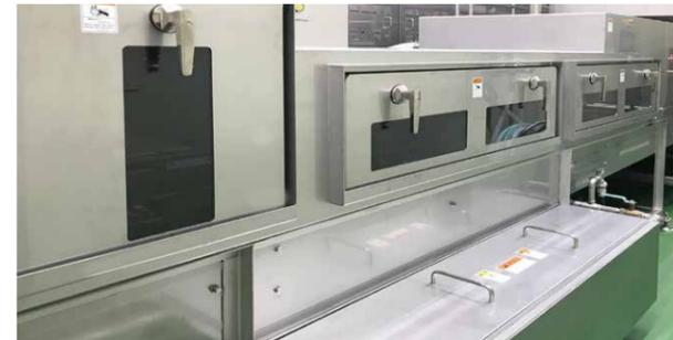
炊飯後の釜や蓋をリターン水※で洗浄。高圧ポンプで残渣なく洗浄できます。その後、新水ですすぎを行いブロウリングを経て、洗浄完了となります。※1次洗浄で使用した水を2次洗浄で再利用しています。仕上げに新水を使用して清潔に洗浄することで、排水を少なくしています。
