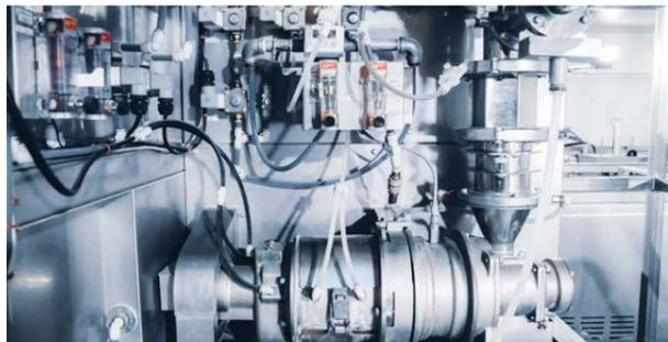
洗米機はサタケ独自の技術により、従来型と比べて大幅な節水が可能。一定水温で効率よく、短時間で洗米します。脱水機の歩留りは98.7%以上※4と高く、浸漬後の碎米発生を抑制します。
