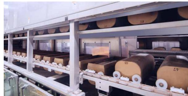
浸漬には専用容器を採用。釜での浸漬に比べて、およそ40%※5の面積を削減し、スペースを有効活用することが出来ます。浸漬が完了したお米は、容器を反転して水切りを行い、炊飯釜に投入して炊き水を供給します。
