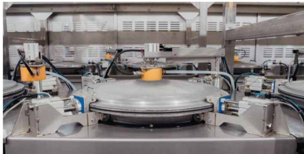
加圧することで、より強い熱が与えられるため、食味劣化が進みにくく、おいしさを長く維持します。また炊飯時は、蓋と釜の4か所をチャック。釜内を高温で均一に保ち、品質のバラつきを抑えます。さらに蒸気は、配管を通して集中排気。常にドライで清潔な環境が保持されます。
