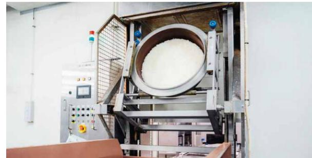
炊き上がったご飯をほくして余分な水分を取ります。ほくし羽根の回転方向やコンベアスピードは自動で制御しており、変更が可能です。反転後、計量どりの番重(トレイ)を、段積みします。
